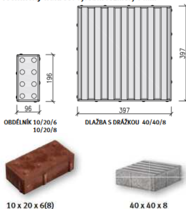
Obr. 1 Betonová zámková dlažba s výstupky pravidelného tvaru
